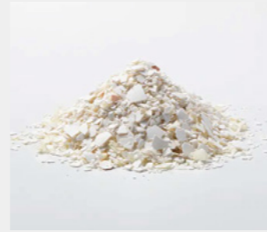
石灰石を卵殻に置き換え。ガラス溶融は約1,500℃で行うため、卵由来のアレルゲンはガラスに残存しない。
