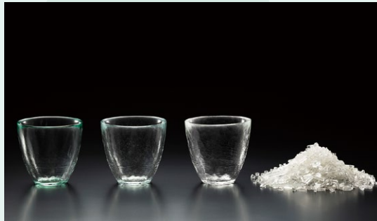
太陽光パネルガラス由来のカレット(右)を用いたガラスコップの試作
