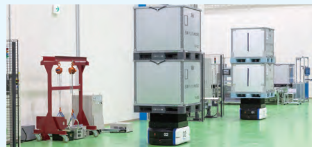
完成したPETボトルプリフォームを入れたコンテナは、自動搬送ロボットによって指定の倉庫に搬送
